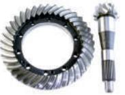
MP-3160-2402020-10 | Комплект шестерён главной передачи для автомобилей УАЗ с мостами «Спайсер». Количество зубьев 37/9. Передаточное число 4,11.                      |
