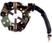
MP-93.3708.009  | Щеточный узел стартера для автомобилей ГАЗ, УАЗ с двигателями ЗМЗ и УМЗ |                                                                                                    |                                                          |
